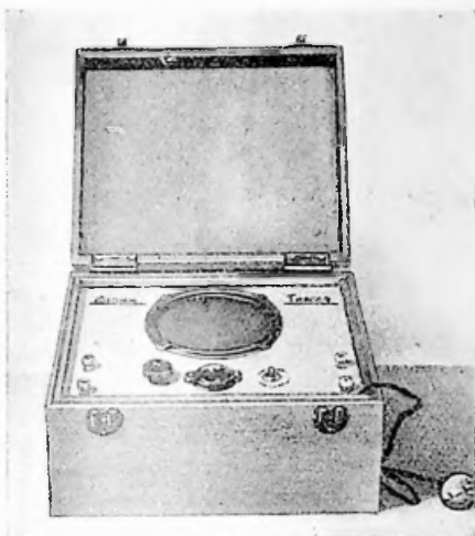
DE SIGNAALTRACER IN ZIJN HOUTEN OMHULSEL MET DEKSEL
